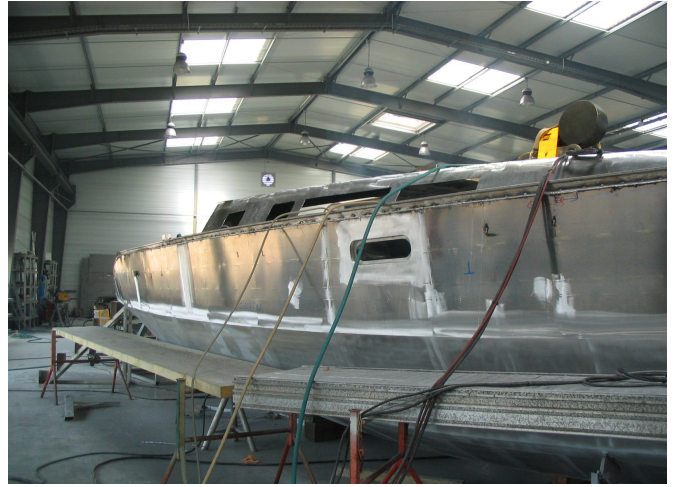
Cette fois il est à l'endroit, le pont vient d'être soudé.
