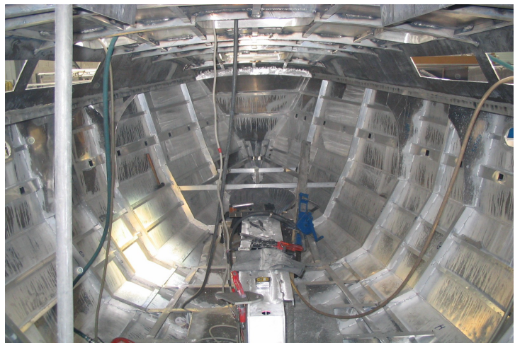
Cette fois il est à l'endroit, le pont vient d'être soudé.
